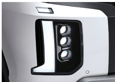
LED DRL + Full LED Headlamps (Hi/Low) ไฟหน้าแบบ Full LED มีระดับการปรับแบบสูงต่ำ พร้อมด้วยไฟส่องสว่างตอนกลางวัน
